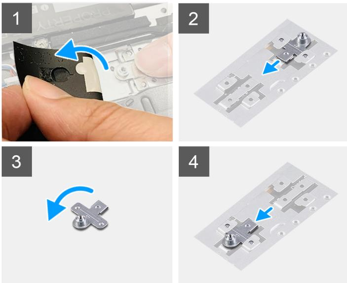
L'immagine seguente fornisce una rappresentazione visiva della procedura per installare la staffa di montaggio dell'unità SSD quando si sostituisce un'unità SSD M.2 2280 con un'unità SSD M.2 2230.
